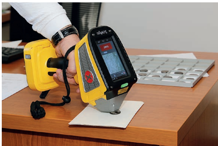
Slika 5. Analiza novca pomoću uređaja x200 SciAps (foto: T. Sesar)
