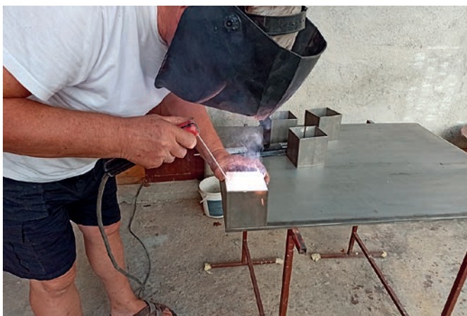
Slika 17. Izrada nosive metalne palete (foto: D. Ordulj)
