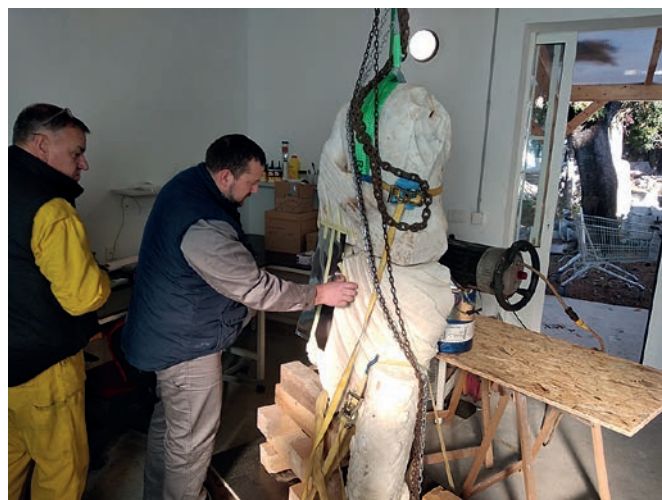
Slika 6. Postavljanje filma u položaj za snimanje (foto: B. Vješnica)
