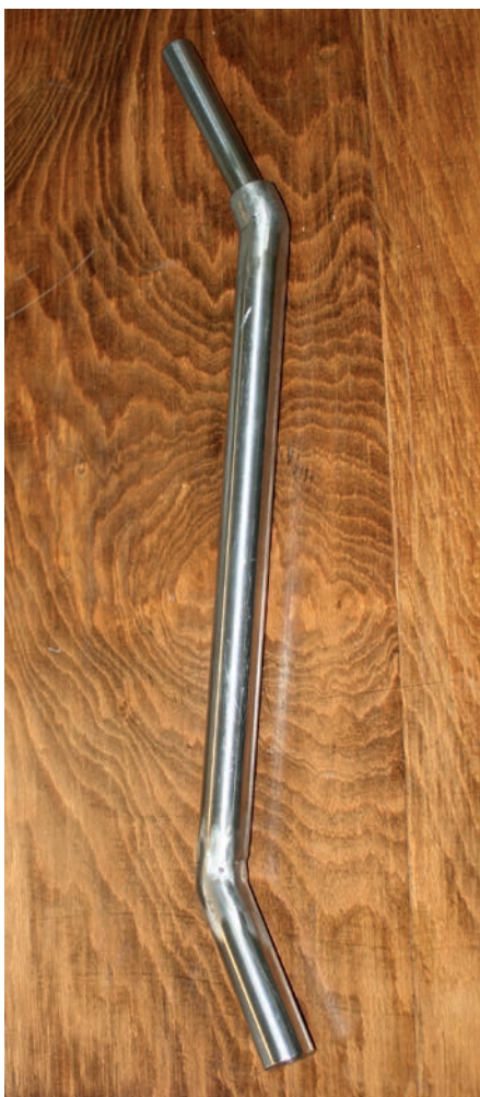
Slika 27. Konačan oblik proteze od inoksa (foto: B. Vješnica)
