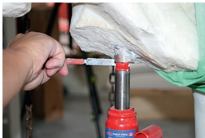
Slika 24. Korištenje male hidraulične dizalice kod fiksiranja usadka od kositrene bronce (foto: B. Vješnica)
