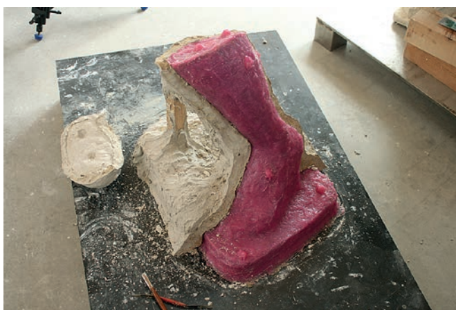
Slika 16. Skidanje gipsane kape s gumenog kalupa (foto: B. Vješnica)
