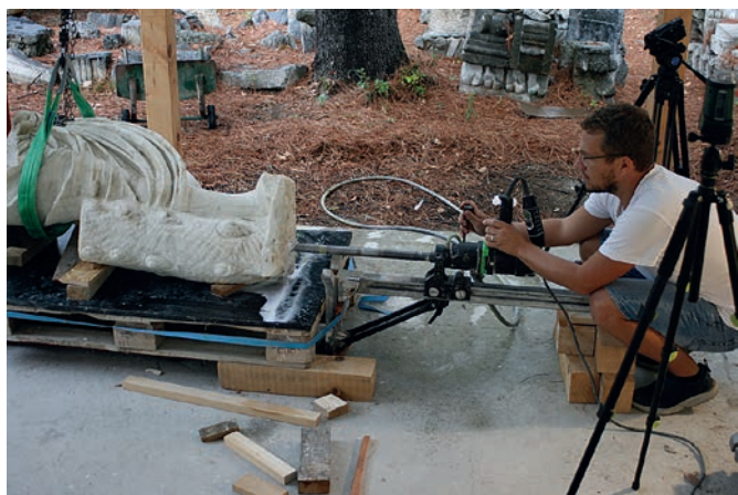
Slika 19. Mokro bušenje dna baze (foto: B. Vješnica)
