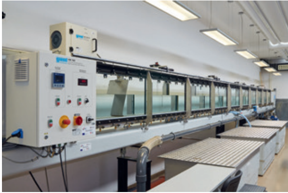
Slika 2. Fotografija eksperimentalnog žlijeba u hidrotehničkom laboratoriju Građevinskog fakulteta u Rijeci unutar kojeg će se provoditi ispitivanja dinamike gibanja čestica MP-a u različitim uvjetima toka tekućine (vode)
