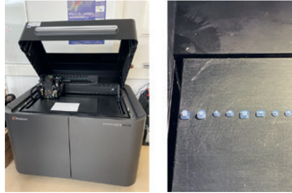
Slika 3. Fotografija 3D printera korištenog za pripremu uzorka čestica mikroplastike s unaprijed definiranim oblicima. Fotografija prikazuje i pripremu uzorka čestica mikroplastike različitih oblika koji uključuju čestice kategorizirane kao (i) prostorni objekti, one kategorizirane kao (ii) ravninski objekti te one kategorizirane kao (iii) linijski objekti. Na fotografiji izrađenih uzorka čestica MP-a valja razlikovati sam uzorak čestice od okolnog podupirućeg materijala koji se uklanja ispiranjem i koji 3D printer koristi za potrebe izrade zadane geometrije.
