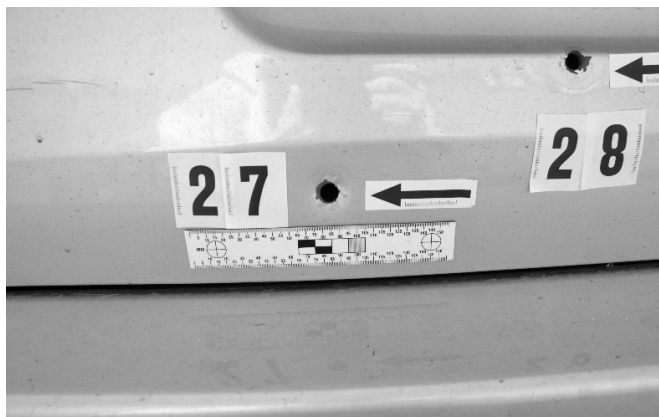
Fotografija 3: Pojedini evidentirani tragovi ulaznih mehaničkih oštećenja na stražnjem kraju vozila koja su nastala ispaljenim hicima iz vatrenog oružja policijskih službenika
