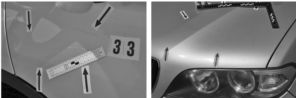
Fotografije 1 i 2: Strelicama su obilježeni tragovi pojedinih mehaničkih oštećenja nastalih naletom vozila na policijske službenike, a koji potječu od policijske opreme i odjeće
