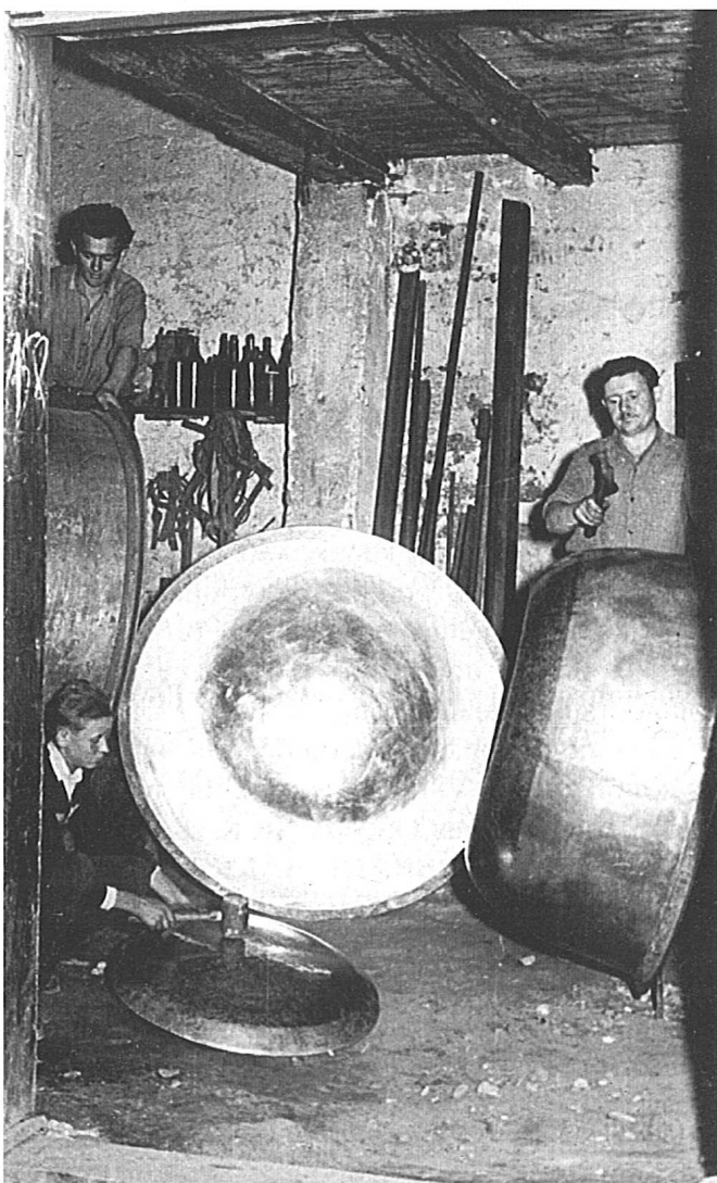
Slika 10 - Bakreni kotao a kuhanje mlijeka, sadržaja 800 litara. Prikazane su sve faze obrade, širen-izbijanje gornji dio, sužavanje-podkupljanje prema dolje, otvaranje okovan gornji rub, bombiranje donji dio dna za uvarivanje, kuglasto uvijanje donji dio kotla i konačno sastavljanje i kositrenje kotla. Desno se vidi utvrđivanje čekićanjem kotla.
