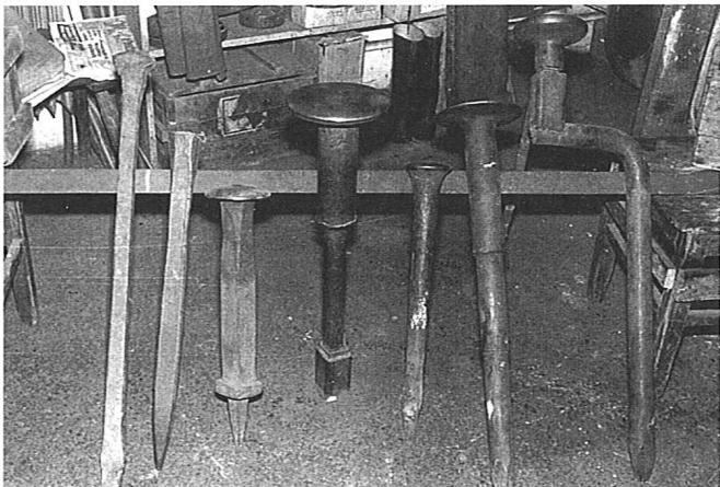
Slika 6 - Izgled ležećeg prihvatnog alata za male usadne alate, različitih oblika, koji se u ovaj ležeći alat usađuju prema zahtjevu obilka elementa koji obrađujemo. Ležeći alat broj 6 vijcima se, na potrebnoj određenoj udaljenosti, čvrsto pritegne.
