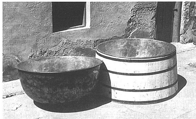
Slika 11 - Rukom oblikovan polukuglasti kotao. Desno, isti kotao montiran u drvenoj bačvi u kojoj je montirana željezna dovodna cijev za dovod pare koja kuha mlijeko. Sve ovo radeno je zanatski, rukom, sastavi tvrdo lemljeni pomoću mjedenih mrvica "šlaglot" drvenim ugljem na običnoj kovačkoj vatri, na nožni pogon. Tako se nekoć radilo. Naravno, danas više nije potrebno, tehnika je usavršila, olakšala i ubrzala izvedbu.
