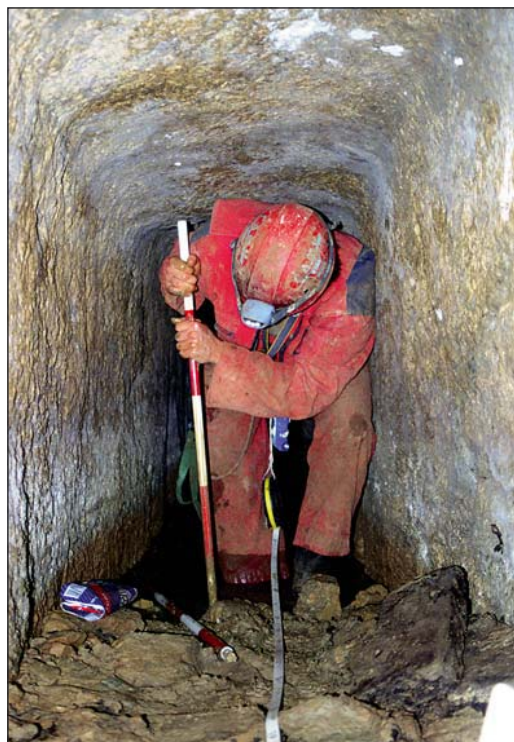
Mjerenje količine mulja u tunelu između 8. i 9. odušnika
