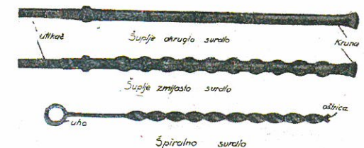
Sl. 8. Svrdla za ručno bušenje stijene. Prema Uratariću, 1947.
