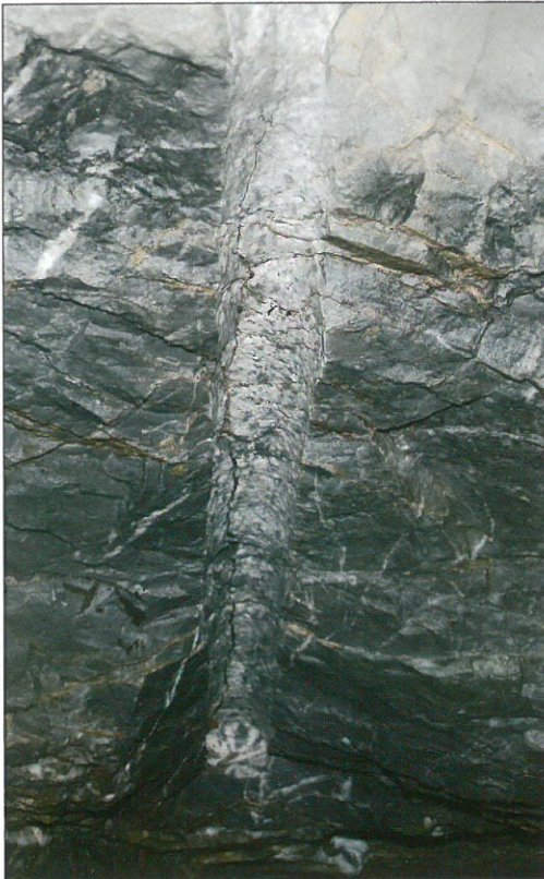
Sl. 9. Rupa za lomljenje bušena u stijeni treće etaže
