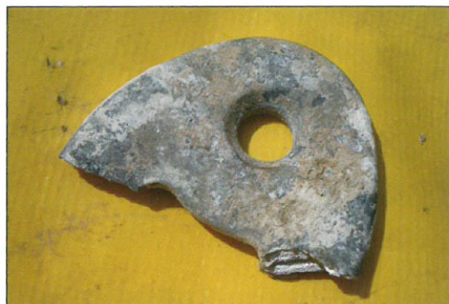
Puknuće ove pločice uzrok je ozljede speleologa
