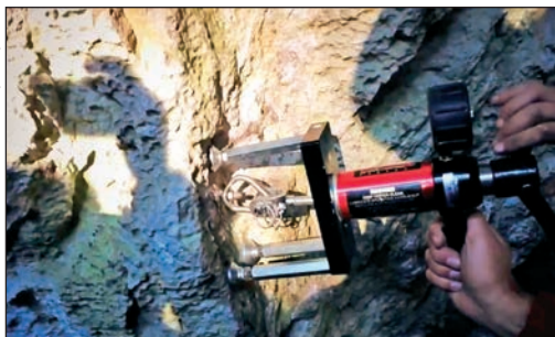
Ispitivanje fikseva u stijeni
