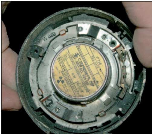
Detektor dima s radioaktivnim američijem
