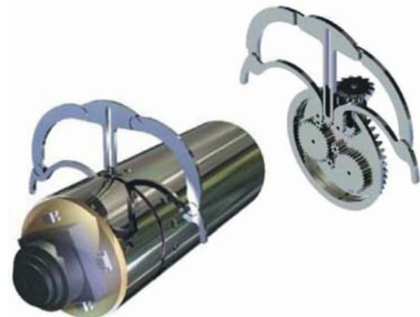
Slika 9 Sidrena noga za stabilizaciju pozicioniranja kapsule [7]
