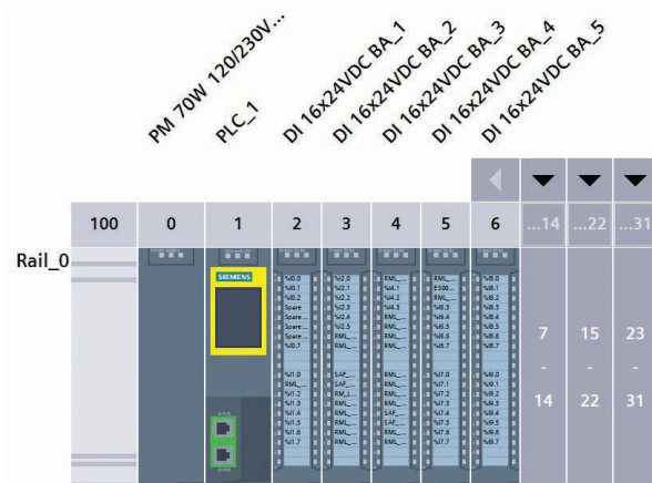
Slika 2 Prikaz hardverske konfiguracije u TIA portalu [2]
