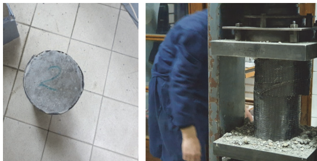
Slika 9. Ispitivanje tlačne čvrstoće betona obavijenog s dva sloja CFRP-a, serija 2
