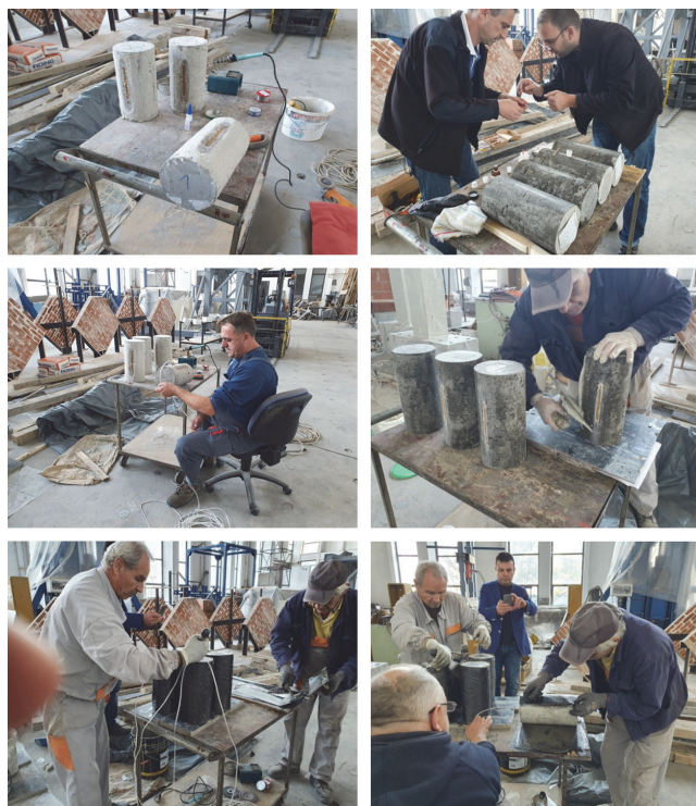
Slika 3. Postavljanje tenzometara na betonske valjke
