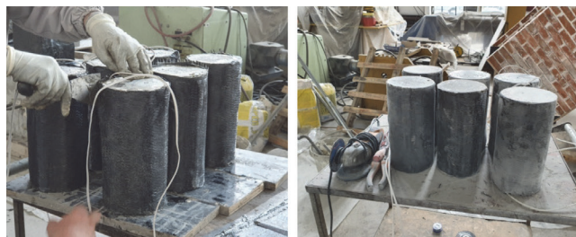
Slika 4. Obavijanje betonskih uzoraka CFRP-om za laboratorijska ispitivanja u ZIM-u, Skoplje
