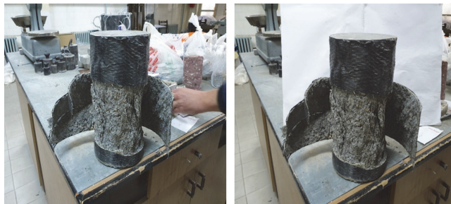
Slika 8. Ispitivanje tlačne čvrstoće betona obavijenog s jednim slojem CFRP-a, serija 1
