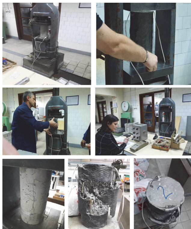
Slika 14. Ispitivanje statičkog modula elastičnosti za sve tri serije uzoraka
