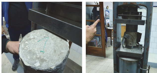
Slika 7. Ispitivanje tlačne čvrstoće betona obavijenog s jednim slojem CFRP-a, serija 1
