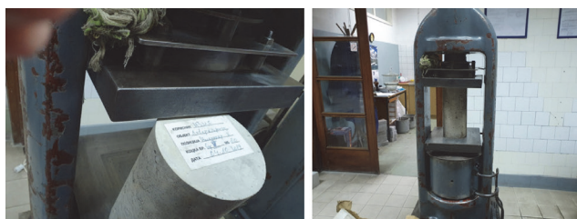
Slika 5. Ispitivanje tlačne čvrstoće običnog betona (serija 0 - bez CFRP-a)
