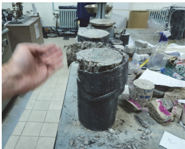
Slika 10. Ispitivanje tlačne čvrstoće betona obavijenog s dva sloja CFRP-a, serija 2
