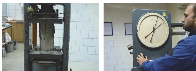
Slika 6. Ispitivanje tlačne čvrstoće običnog betona (serija 0 - bez CFRP-a)
