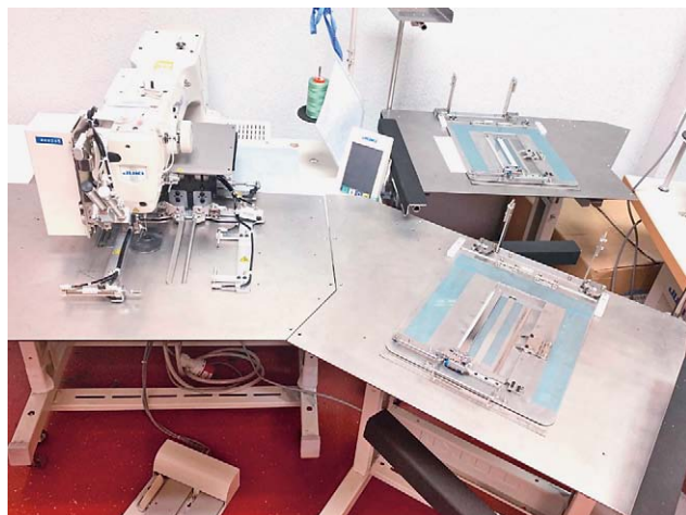
Sl.2 URIHO - Suvremeni strojevi za postizanje proizvoda visoke kvalitete: (lijevo) šivaći stroj za izradu vratnog izreza na polo majicama, JUKI AMS 221EN, (desno) šivaći stroj za prošivanje čičak vrpca s kompjutersko upravljanim šivanjem uz šablone, JUKI tip AMS-210ENHL 2210
