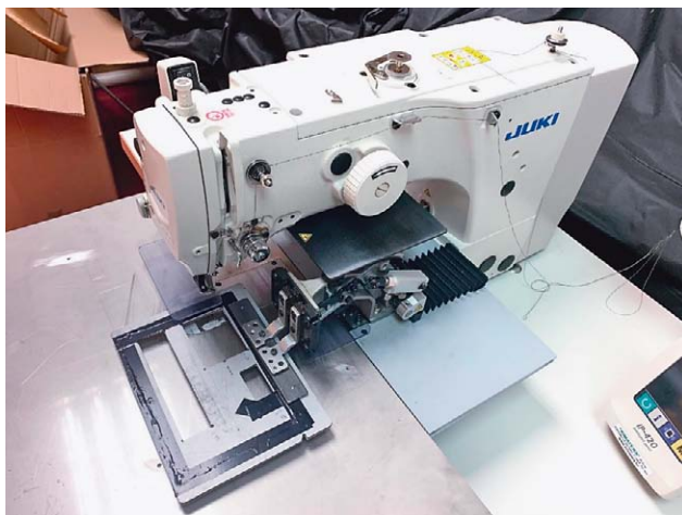
Sl.2 URIHO - Suvremeni strojevi za postizanje proizvoda visoke kvalitete: (lijevo) šivaći stroj za izradu vratnog izreza na polo majicama, JUKI AMS 221EN, (desno) šivaći stroj za prošivanje čičak vrpca s kompjutersko upravljanim šivanjem uz šablone, JUKI tip AMS-210ENHL 2210
