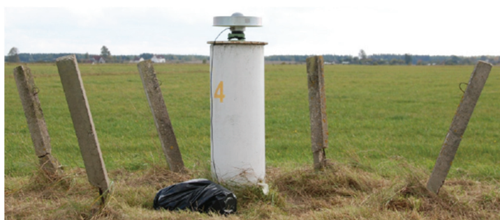
Slika 11. GNSS-mjerenja na kalibracijskoj bazi Kyviškes (Jokela i dr. 2009).
