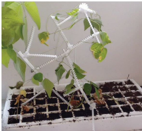
Slika 6 Prototip štapova i čvorova bez ugrađene elektronike u projektu Flora Robotica [14]
