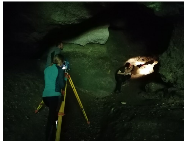
Slika 22. | Izmjera špilje Vindije totalnom stanicom (geodetskim uređajem) i izrada speleološkog nacрта | Foto: Valentina Kraš
