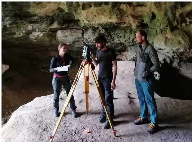
Slika 21. | Izmjera špilje Vindije totalnom stanicom (geodetskim uređajem) i izrada speleološkog nacрта | Foto: Valentina Kraš
