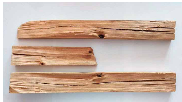
Figure 9 Characteristic defects after extreme drying and/or thermal modification Slika 9. Karakteristične greške nakon intenzivnog sušenja i/ili toplinske modifikacije
