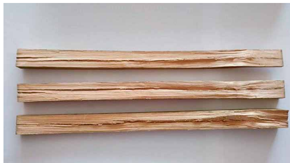
Figure 9 Characteristic defects after extreme drying and/or thermal modification Slika 9. Karakteristične greške nakon intenzivnog sušenja i/ili toplinske modifikacije
