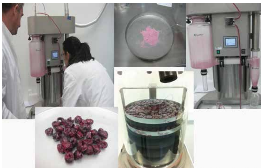
Slika 4: Prerada plodova višnje Maraske liofilizacijom te proizvodnja praha soka višnje Maraske
