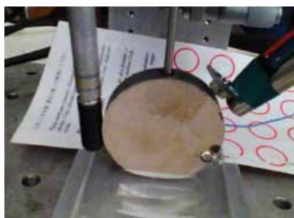
Slika 3: Prikaz elektromehaničke i temperaturne karakterizacije piezokeramičkog elementa
