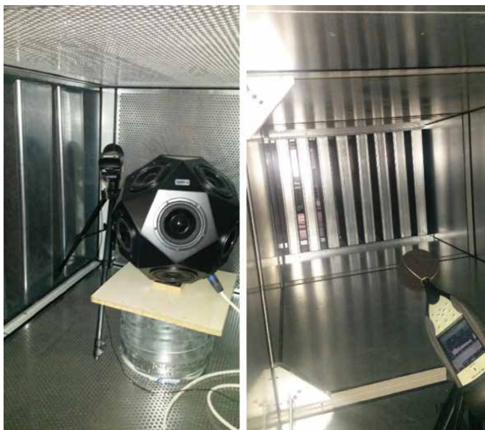
Slika 10: Mjerni sustav za određivanje unesenog i prenesenog prigušenja kulisnih prigušivača
