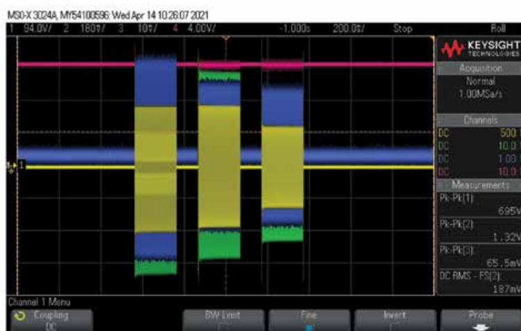
Slika 8: Optimizirani signali napona, struje i pomaka na vrhu pretvarača u svrhu tretiranja algi
