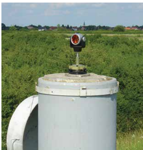
Slika 3: Mjerenje duljina preciznim elektrooptičkim daljinomjerom Leica TCA2003 na kalibracijskoj bazi [2]
