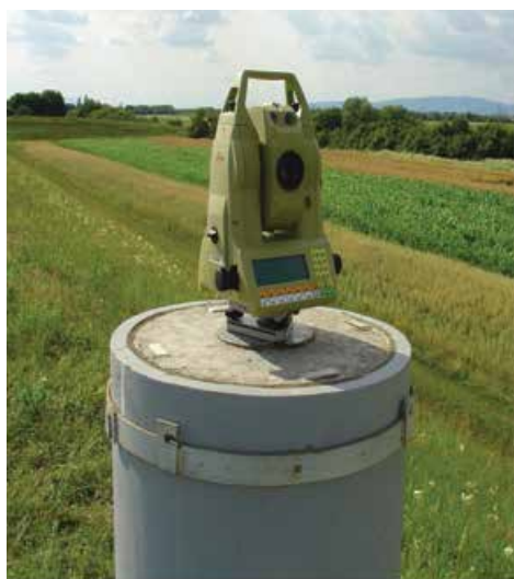
Slika 3: Mjerenje duljina preciznim elektrooptičkim daljinomjerom Leica TCA2003 na kalibracijskoj bazi [2]
