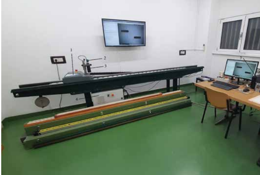
Slika 7: Komparator Geodetskog fakulteta s izmijenjenim dijelovima (1 – kolica sa servomotorom, 2 – kamera s CCD senzorom, 3 – telecentrični objektiv, 4 – upravljačko računalo, 5 – serversko računalo) [5]
