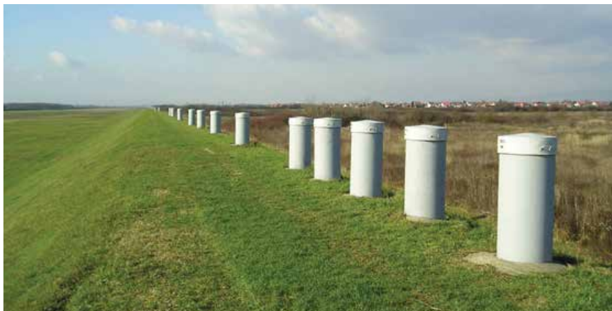
Slika 2: Kalibracijska baza Geodetskog fakulteta Sveučilišta u Zagrebu [2]
