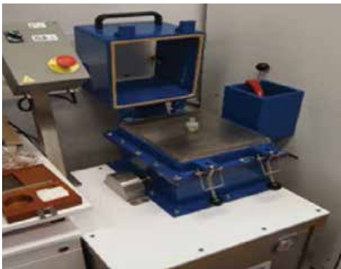
Slika 2: Fotografija uređaja za odvajanje frakcija pomoću sita - tip Somerville - model SF-10
