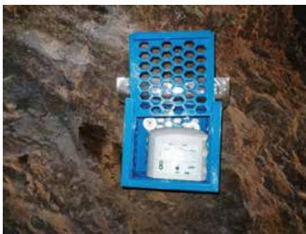
Slika 7: Instalirani uređaj za mjerenje koncentracije radona.
