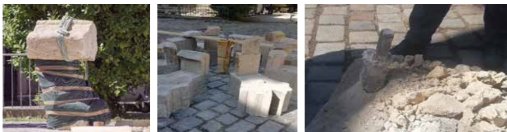
Slika 7: Probna miniranja sa simulacijom stvarnih uvjeta
