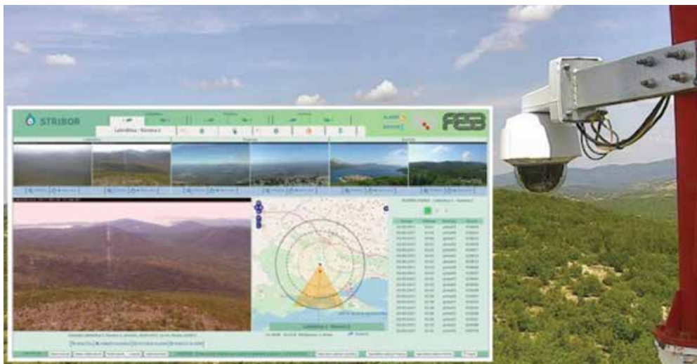
Slika 7: Motrilačka jedinica sustava OiV Fire Detect AI i izgled operativnog ekrana
