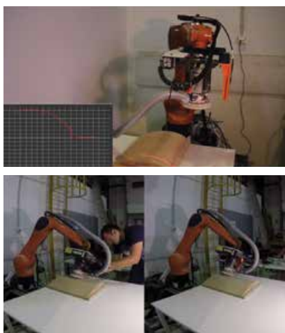
Slika 9: Robotska brusna stanica
