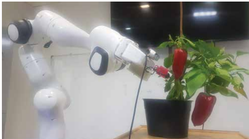
Slika 6: Primjera robota Franka za branje paprika u projektu Specularia
