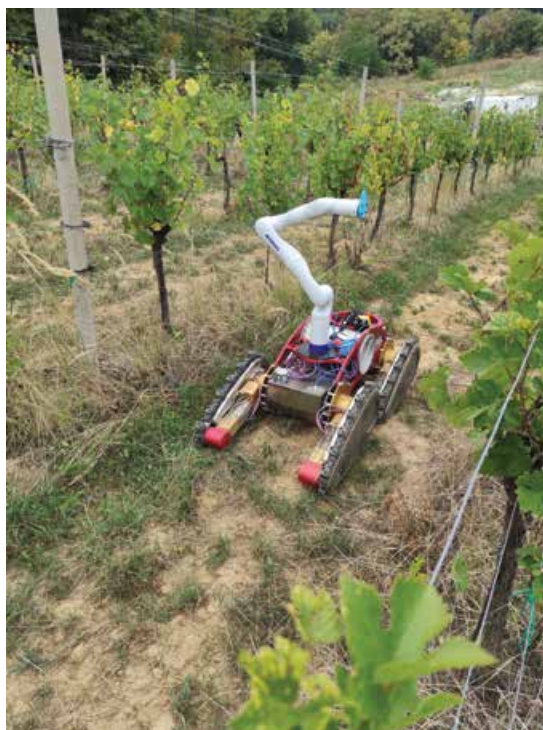
Slika 4: Autonomno mobilno vozilo za radove u vinogradu, razvijano u projektu Hektor - prvi eksperimenti u vinogradu Jazbina 2021. godine
