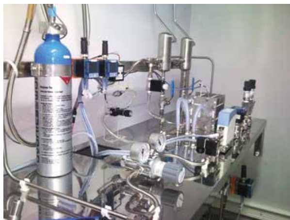
Slika 5: Eksperimentalni postav za istraživanje vodikove tehnologije u sklopu LARES-a (lijevo je metalhidridni spremnik, a u središnjem dijelu fotografije, u pozadini, je svežanj gorivnih članaka).
