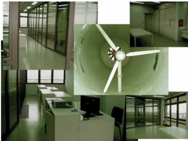
Slika 4: Laboratorijski vjetroagregat u vjetrotunelu i uređeni laboratorijski prostori na 13. katu neboderske zgrade FERa.
