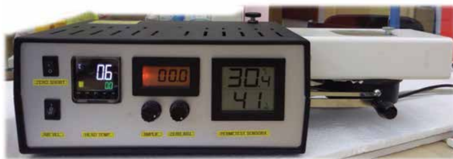
Slika 12: Uređaj za nedestruktivno mjerenje otpora prolazu topline i propusnosti vodene pare i otpora prolazu vode, Permetest
