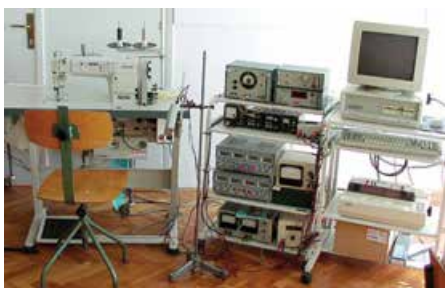
Slika 3: Usavršeni i patentirani mjerni sustav za mjerenja procesnih parametara šivanja
