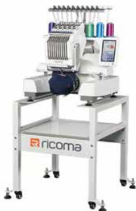
Slika 20: Suvremeni numerički vođen šivaći stroj za ukrasni vez, 1010, Ricoma
