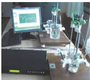
Slika 7: Sustav za mjerenja početnog i kasnijih promjena volumena
