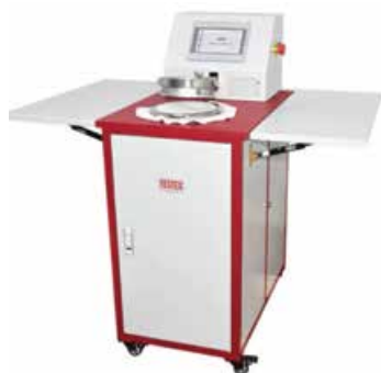
Slika 31: Uređaj za mjerenja zrako- propusnosti tekstilnih materijala i odjevnih kompozita
