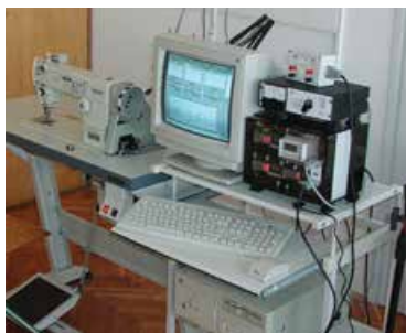
Slika 5: Mjerni sustav za mjerenja procesnih parametara šivanja s dva mikroručunala
