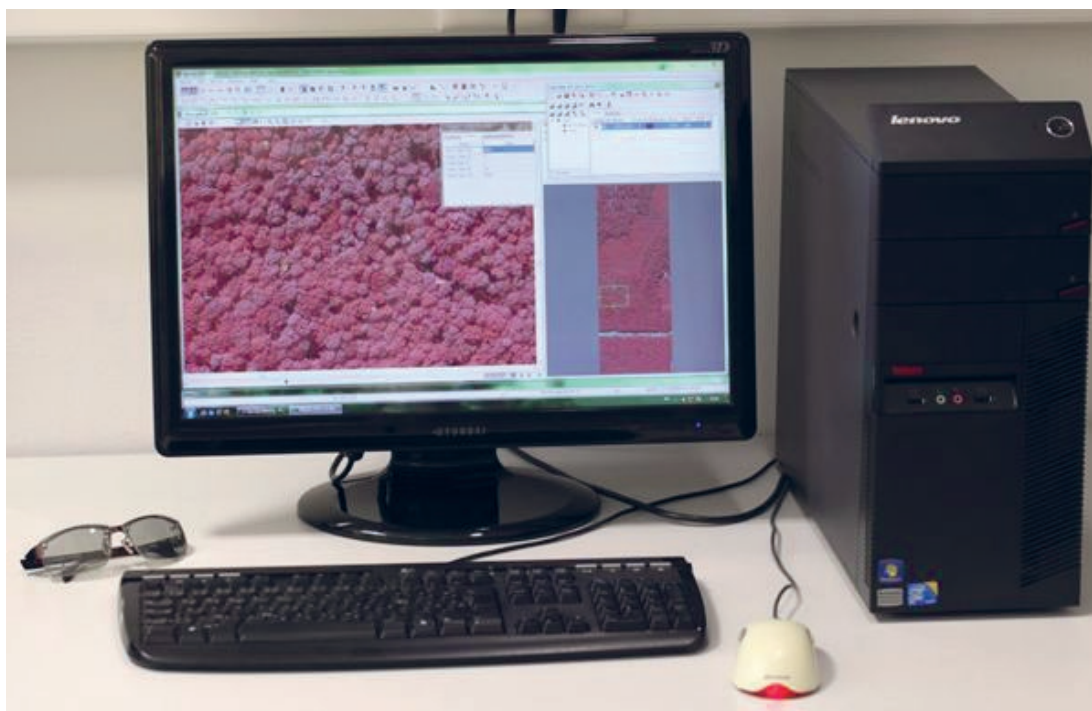
Slika 4. Digitalna fotogrametrijska stanica za interpretaciju digitalnih snimaka u stereomodelu
