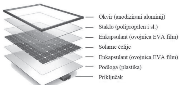
Slika 1. Elementi solarnog modula
