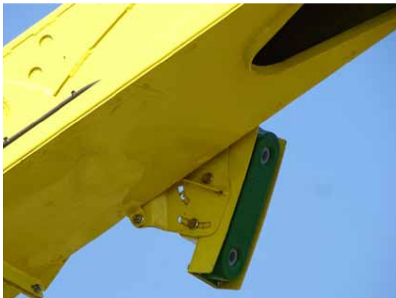
Slika 5. Kamera postavljena je na provodnoj (odvodnoj) cijevi za izbacivanje sječke. Figure 5. Camera is mounted on a spout to eject the chip.
