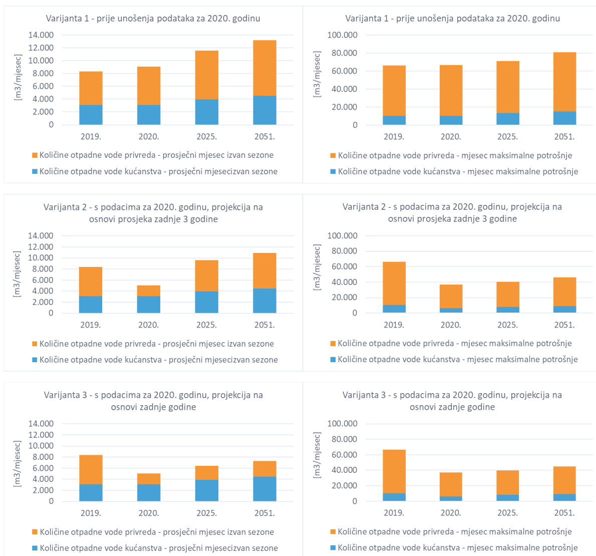
Slika 3: Količine otpadne vode koje dolaze na UPOV Rabac (hidrauličko opterećenje) po kategorijama potrošača za 3 razmatrane varijante u prosječnom mjesecu izvan turističke sezone (u stupcu lijevo) i u mjesecu maksimalne potrošnje (u stupcu desno)
