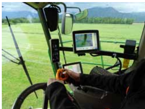
Slika 6. Suvremeni silažni kombajni imaju u kabini više zaslona. Sa njima se nastavlja ili prati radne parametre silažnog kombajna. Primjer kabine silažnog kombajna John Deere
