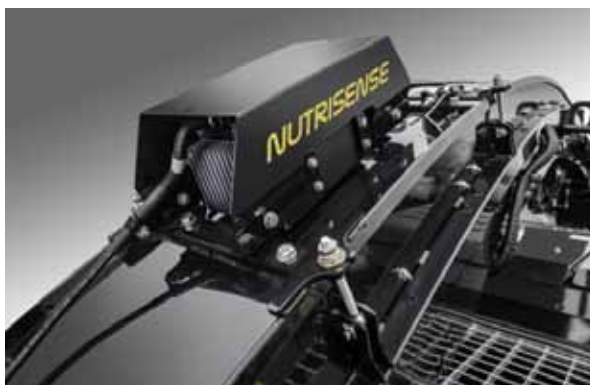
Slika 4. New Hollandov NutriSense sustav s NIR analizatorom. Izvor slike: New Holland
