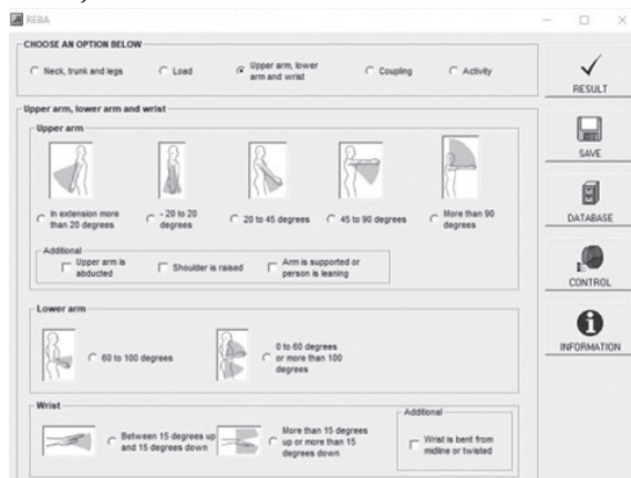
Slika 2. Prikaz matrice za ocjenu položaja ruku pomoću računalnog programa ErgoFellow (modul REBA) Figure 2. Display of hand position assessment matrix using a computer program ErgoFellow (REBA modul)
