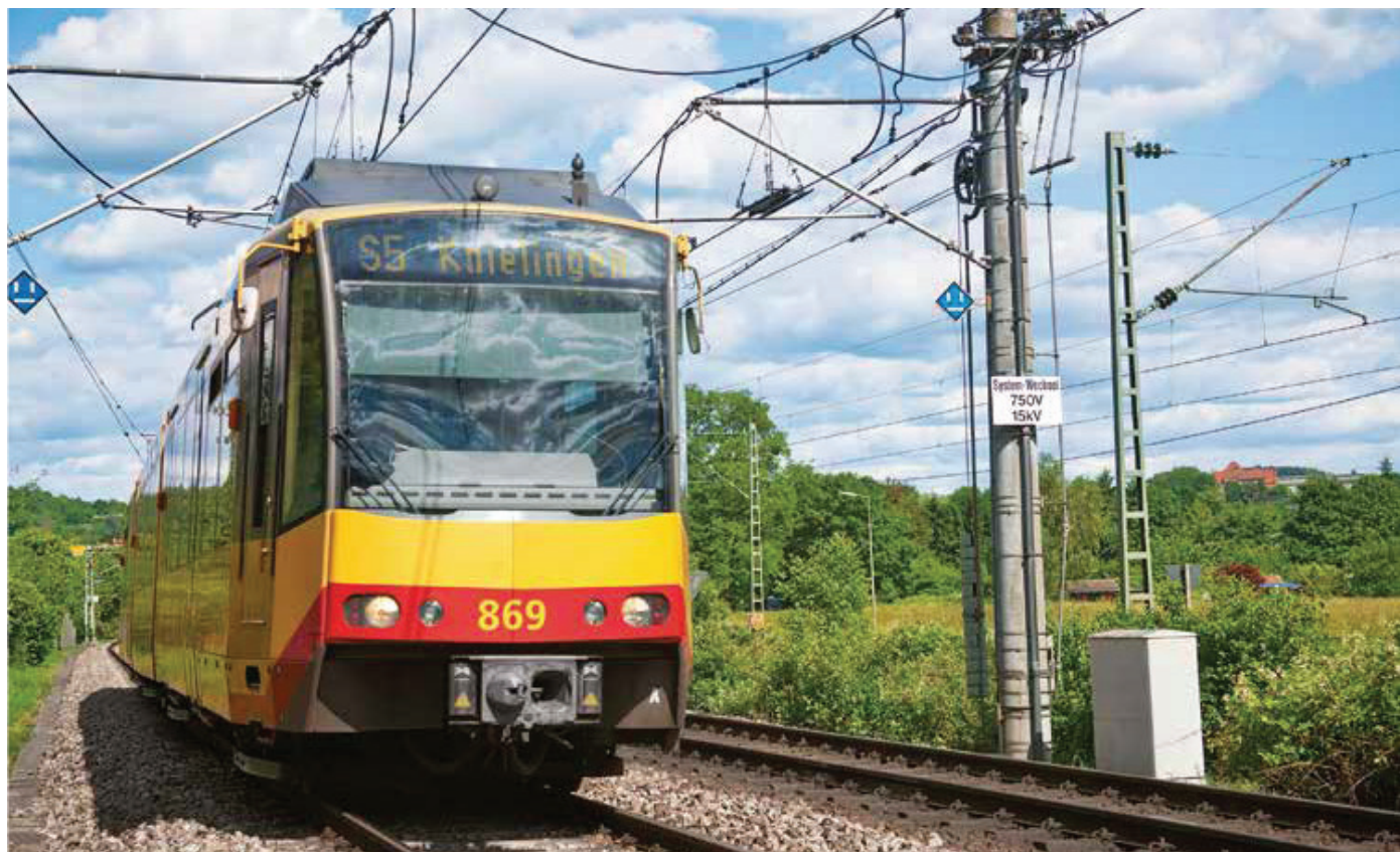
Slika 4. Prelazak između različitih sustav napajanja
