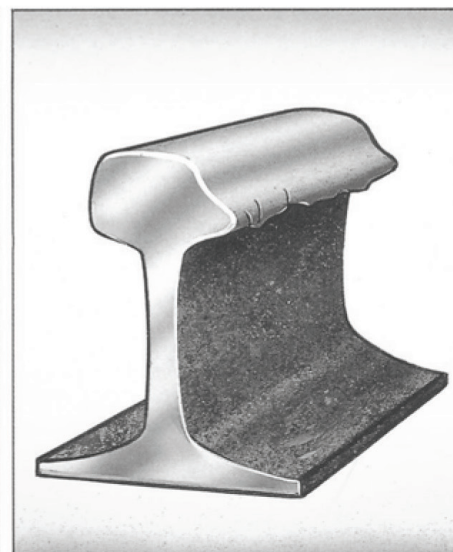
Slika 2. Bočna istrošenost tračnica
