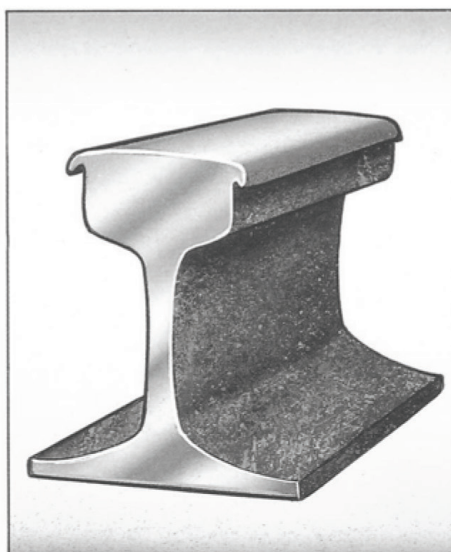
Slika 1. Visinska istrošenost tračnica
