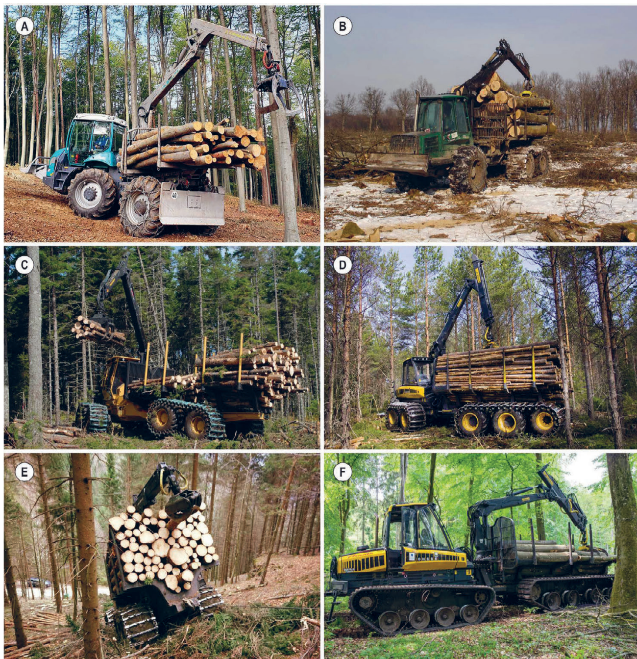
Slika 1. Različite izvedbe forvardera Fig. 1 Different forwarder designs
