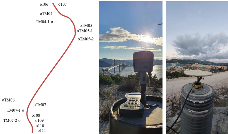
Slika 5. Geodetska osnova za potrebe gradnje mosta (lijevo), referentni uređaj postavljen na oTM05 (sredina) i referentni uređaj postavljen na TM07-1.
