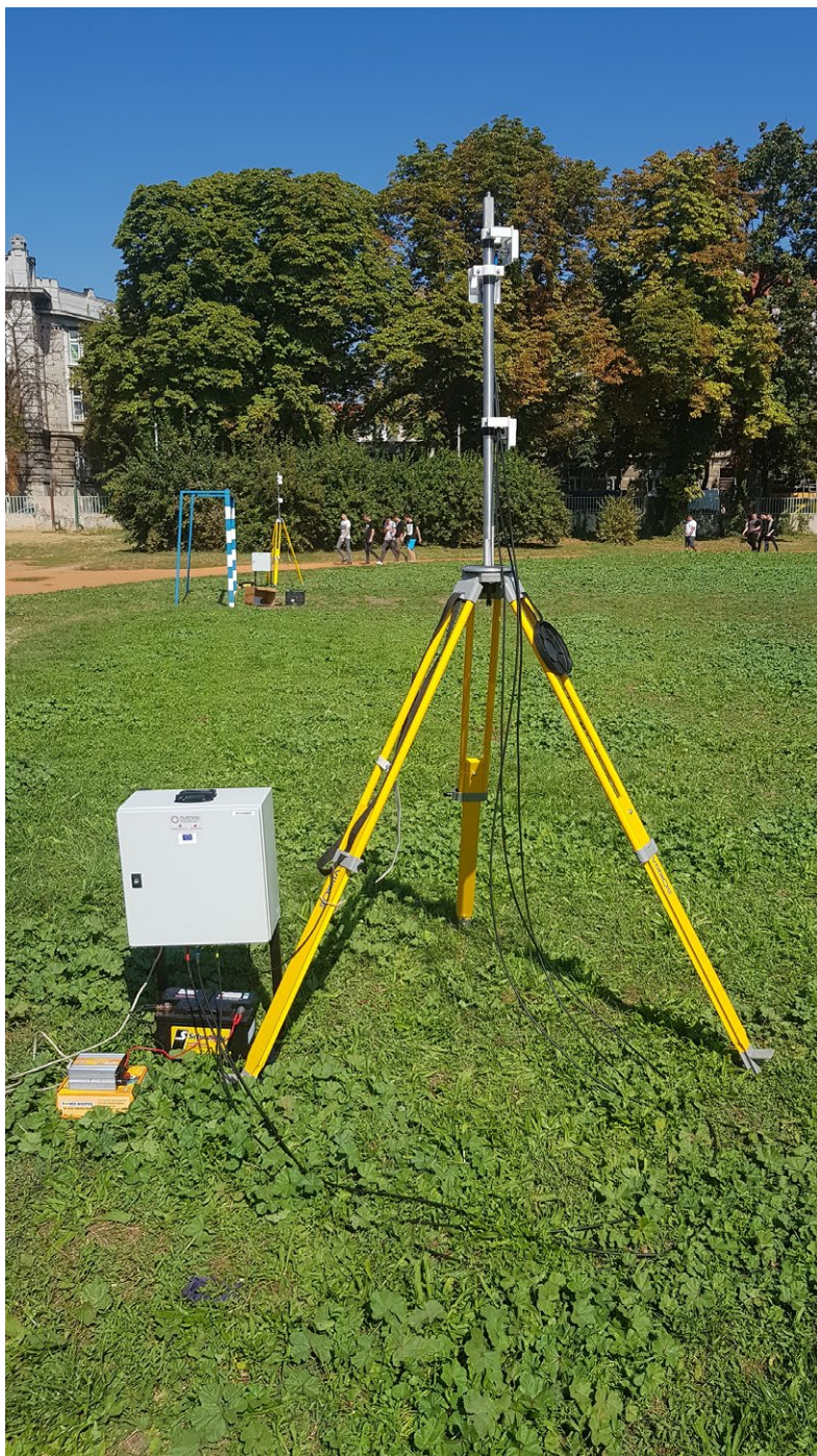
Slika 2. LocataLite primopredajnik spojen na 3 antene postavljene na nosač fiksiran na stativu.
