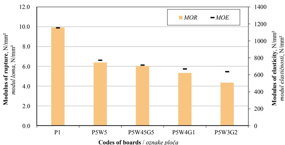
**Figure 6** MOR and MOE values of boards**Slika 6.** Vrijednosti modula loma i modula elastičnosti
