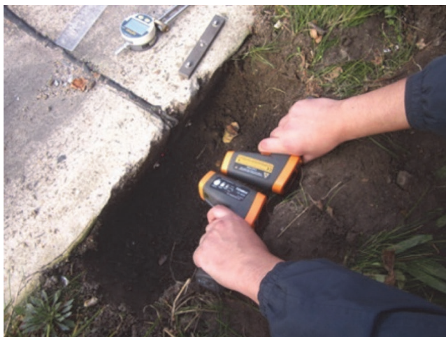
Slika 4. Mjerenje širine pukotine uređajem (lijevo) i temperature kolnika izmjerene infracrvenim termometrom (desno) [19]
