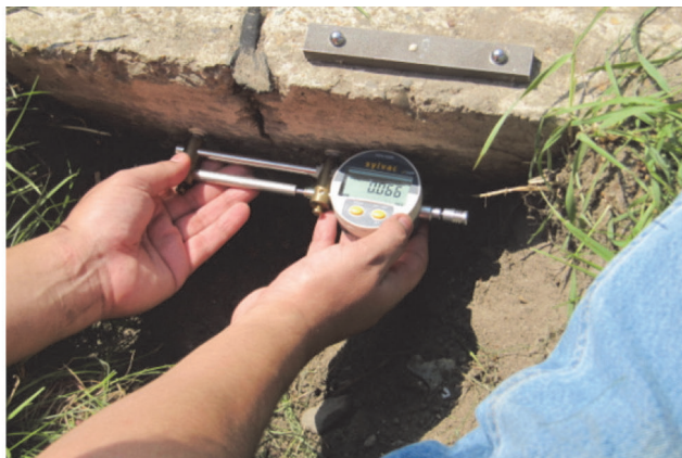
Slika 4. Mjerenje širine pukotine uređajem (lijevo) i temperature kolnika izmjerene infracrvenim termometrom (desno) [19]
