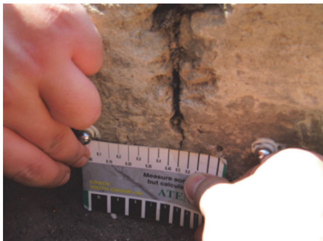
Slika 4. Mjerenje širine pukotine uređajem (lijevo) i temperature kolnika izmjerene infracrvenim termometrom (desno) [19]
