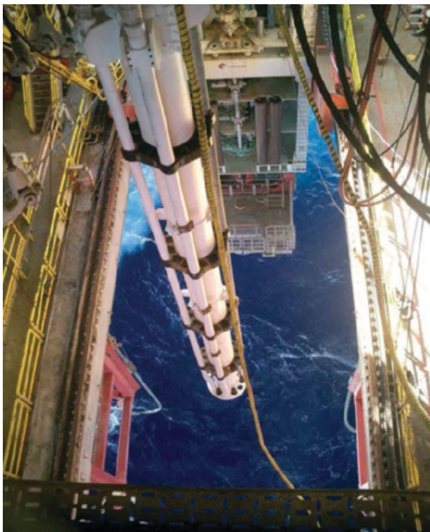
Slika 12. Prikaz usponskih cijevi i pridruženih vodova (Krištafor, 2021)
