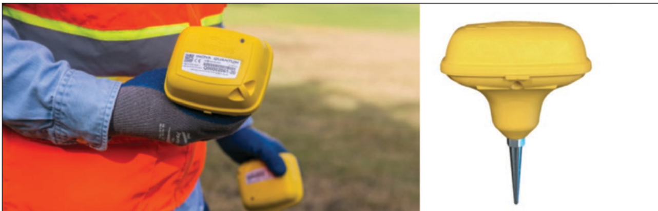
Slika 2. Primjer Quantum/Tremornet noda
