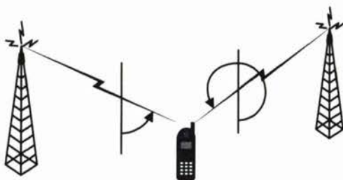
Slika 6. Metoda određivanja položaja mjerenjem kuta.
