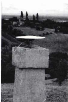
Slika 2. Antena GPS-prijamnika na produžnom štapu na stupu trigonometrijske točke Brusnik.
