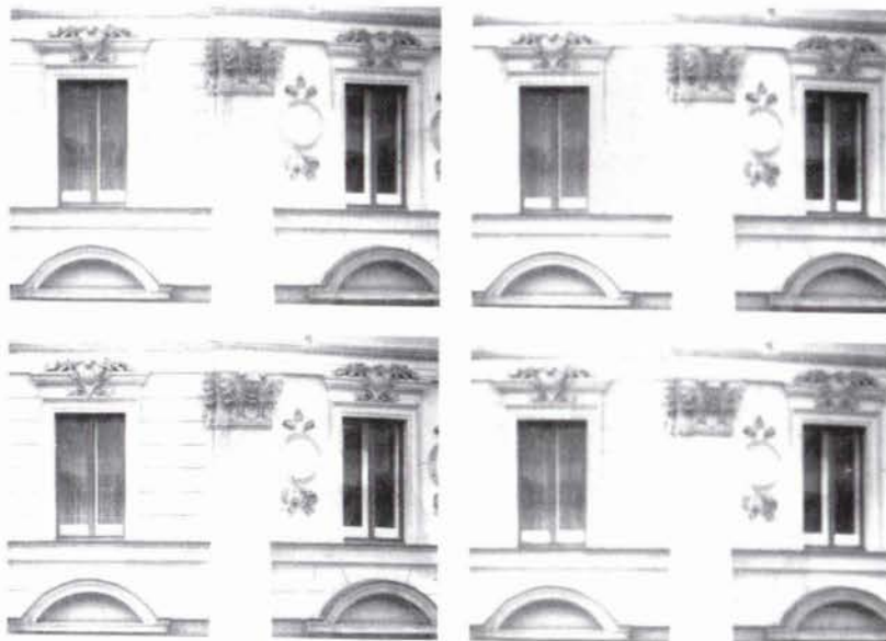
Slika 4. Primjena filtriranja: gore lijevo-originalna slika; gore desno primjena Median filtra; dolje lijevo primjena visokopropusnog filtra; dolje desno primjena niskopropusnog filtra (Roić 1996).
