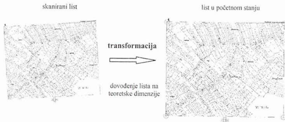
Slika 8. Dovođenje lista na teoretske dimenzije.
