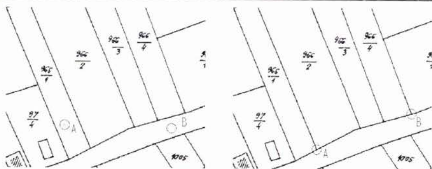
Slika 7. Primjer loše i dobre uspostave lokalnog sustava.
