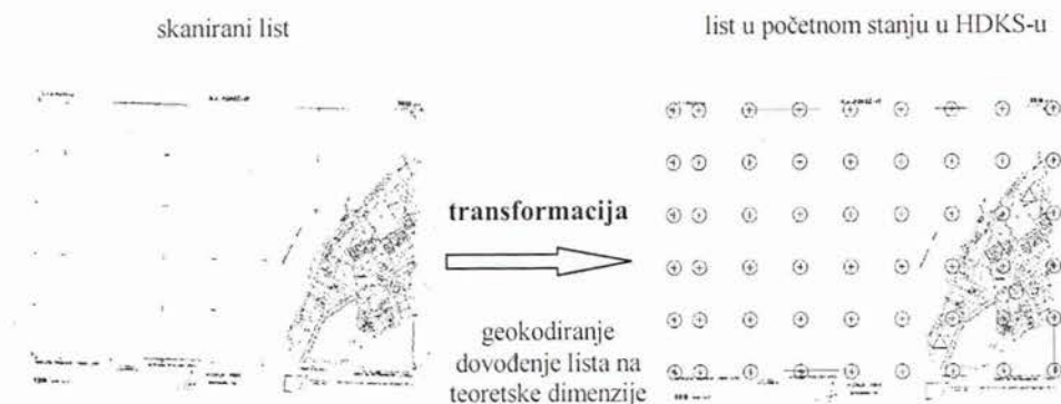
Slika 9. Geokodiranje rasterskog plana.
