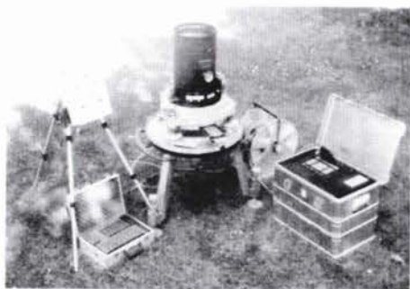
Slika 1. Zenit-kamera sa pripadajućom opremom (lijevo) i Ni 2 astrolab (desno).
